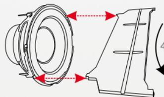
Positionieren Sie den Lautsprecher im Befestigungsring und klicken diesen mit Hilfe des Rastwerkzeuges ein. (Gegen den Uhrzeigersinn)
