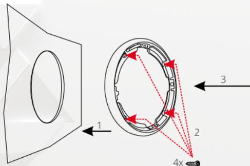
Positionieren Sie den Lautsprecher-Befestigungsring und schrauben ihn mit den 4 mitgelieferten Schrauben fest.
